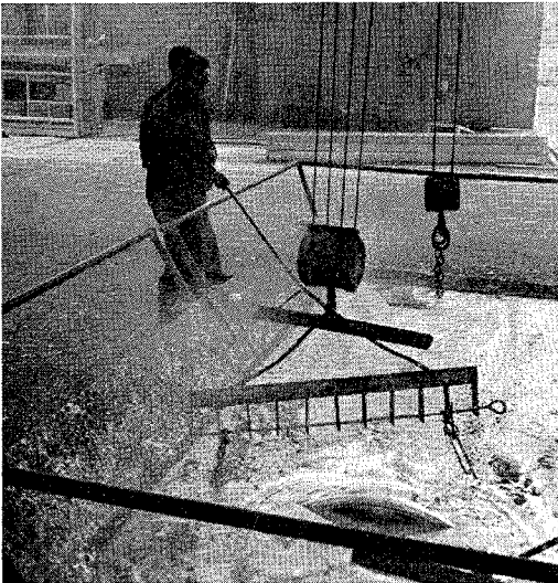
Abb.1 Das Schwenken des eingetauchten Gutes. Arbeit mit leichtem Kraftaufwand in aufrechter oder leicht gebeugter Körperhaltung. Beim vorliegenden Zinkbad wird ein zu niedriges Geländer verwendet, das ein Vornüberkippen nicht verhindert und auch für das Abstützen der Arme oder Werkzeuge wenig geeignet ist.
