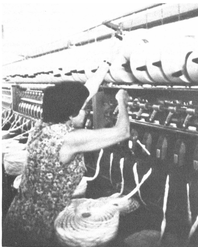
Abb. 1. Spulenwechsel an einer Openend-Spinnmaschine. Die Spule ist zu hoch, die Frau streckt sich nach oben
