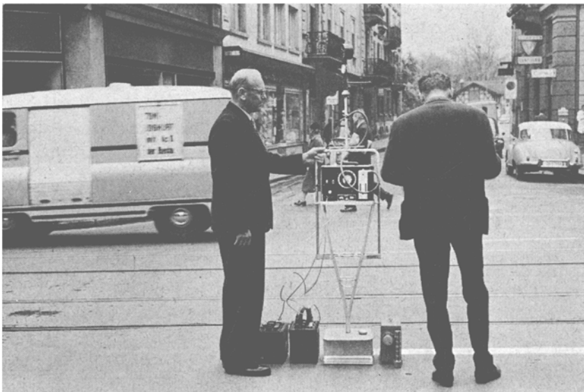
Abb. 1 Meßeinrichtung zur Bestimmung des CO-Gehaltes und der Windverhältnisse im Einsatz.
